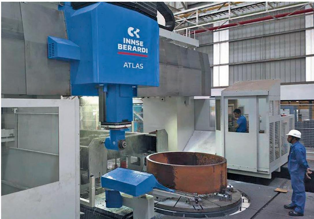
1 Schwere vertikale Portalmaschine ›Atlas‹ von Innse-Berardi in Gantry-Bauweise: auch leistungsfähige Drehtische werden kundenspezifisch integriert
